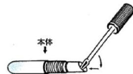
スティックを斜め上より本体に差し込みパチンと音がするまで押し込む
